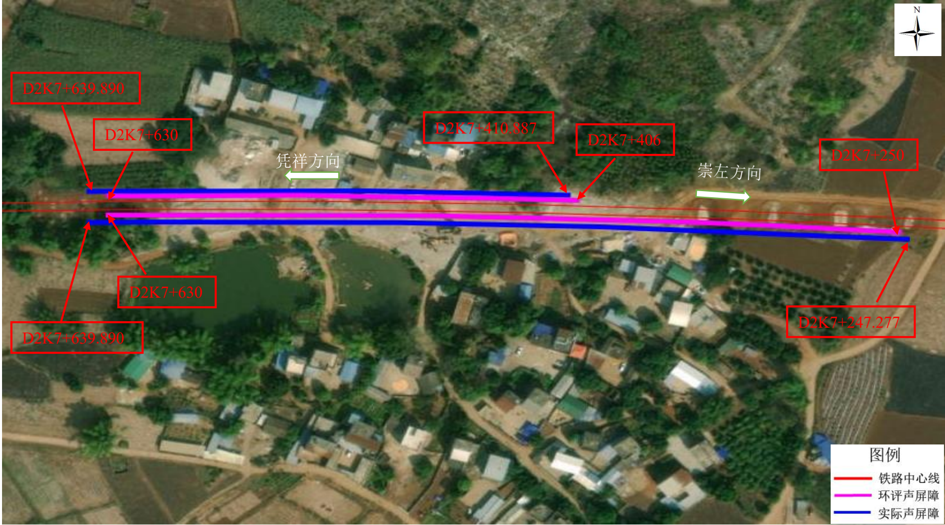
图 6.3-2 (a) 邕板实际与环评阶段声屏障位置关系示意图 (声屏障增加 17.6m)
