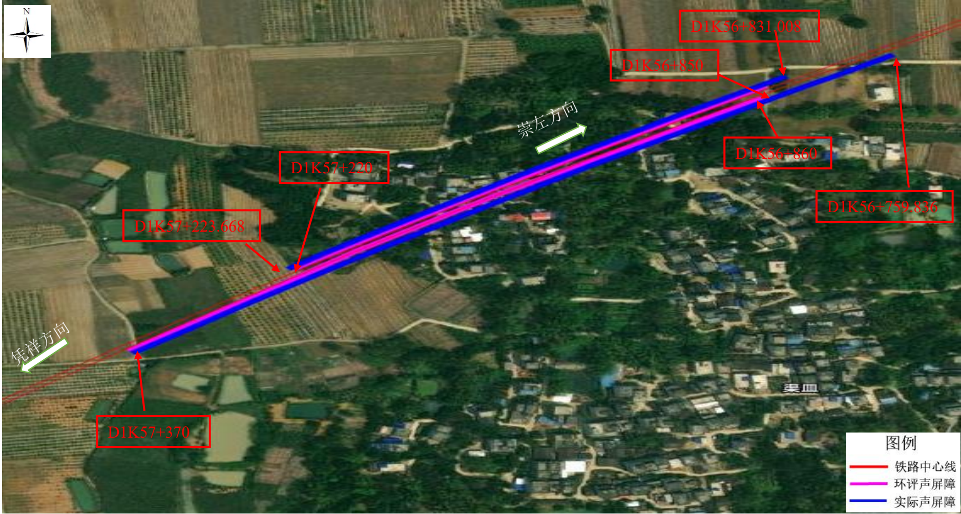
图 6.3-5 (a) 渠皿实际与环评阶段声屏障位置关系示意图 (声屏障增加 122.82m)
