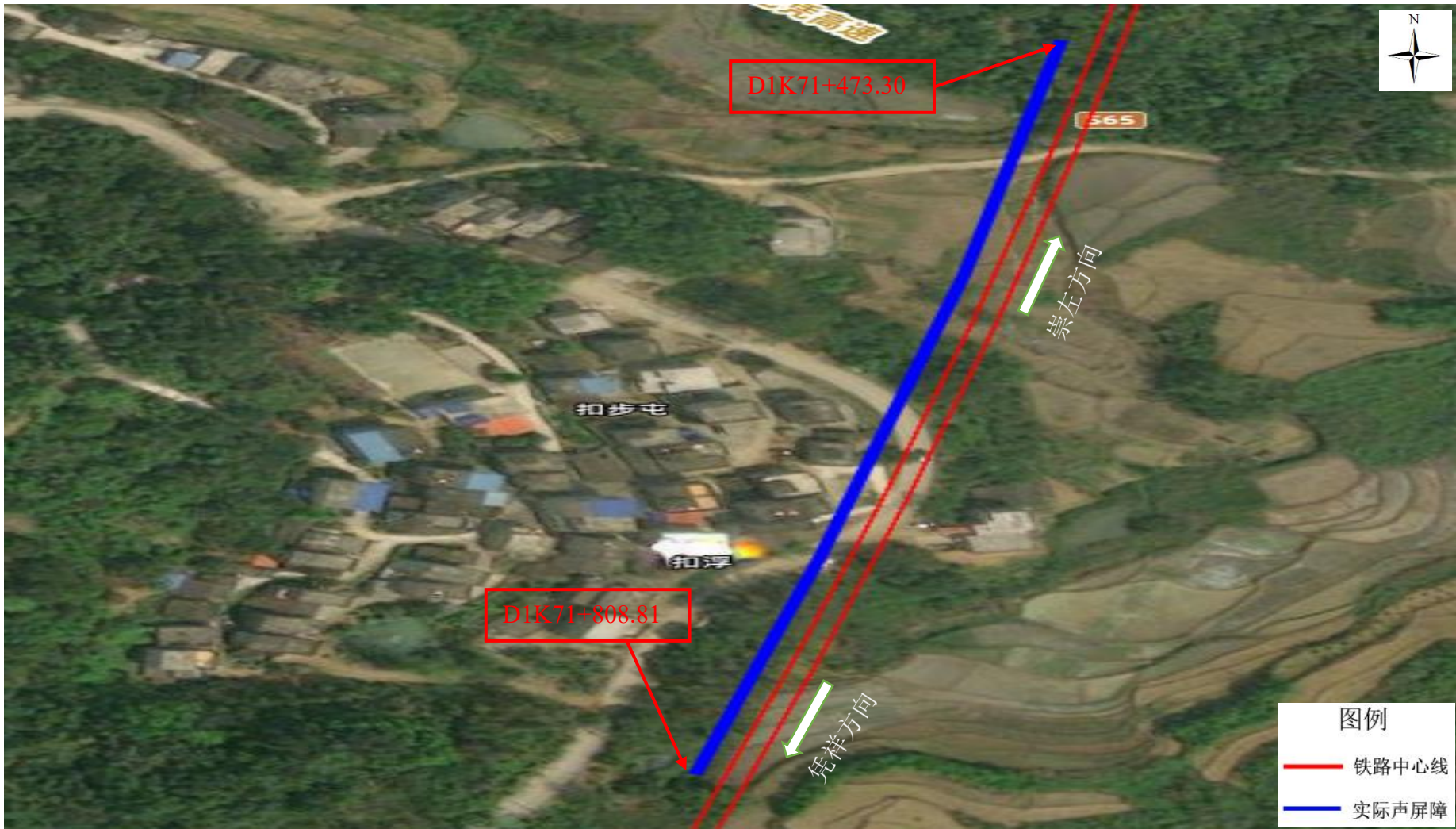
图 6.3-6 (a) 扣步实际与环评阶段声屏障位置关系示意图 (环评未设置声屏障, 实际增加 335.51m)
