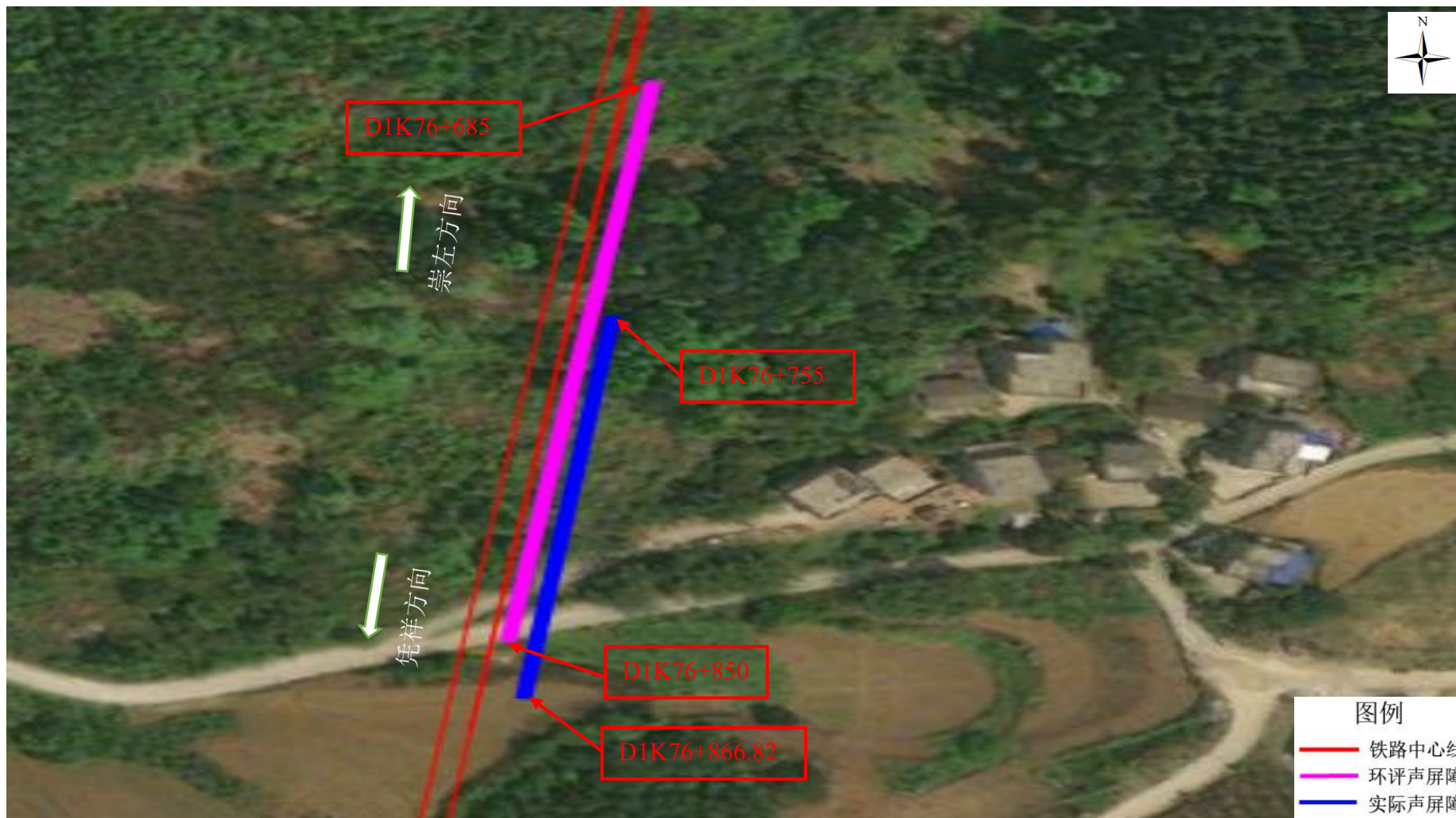
图 6.3-7 (a) 白龙村实际与环评阶段声屏障位置关系示意图 (减少 53.18m)
