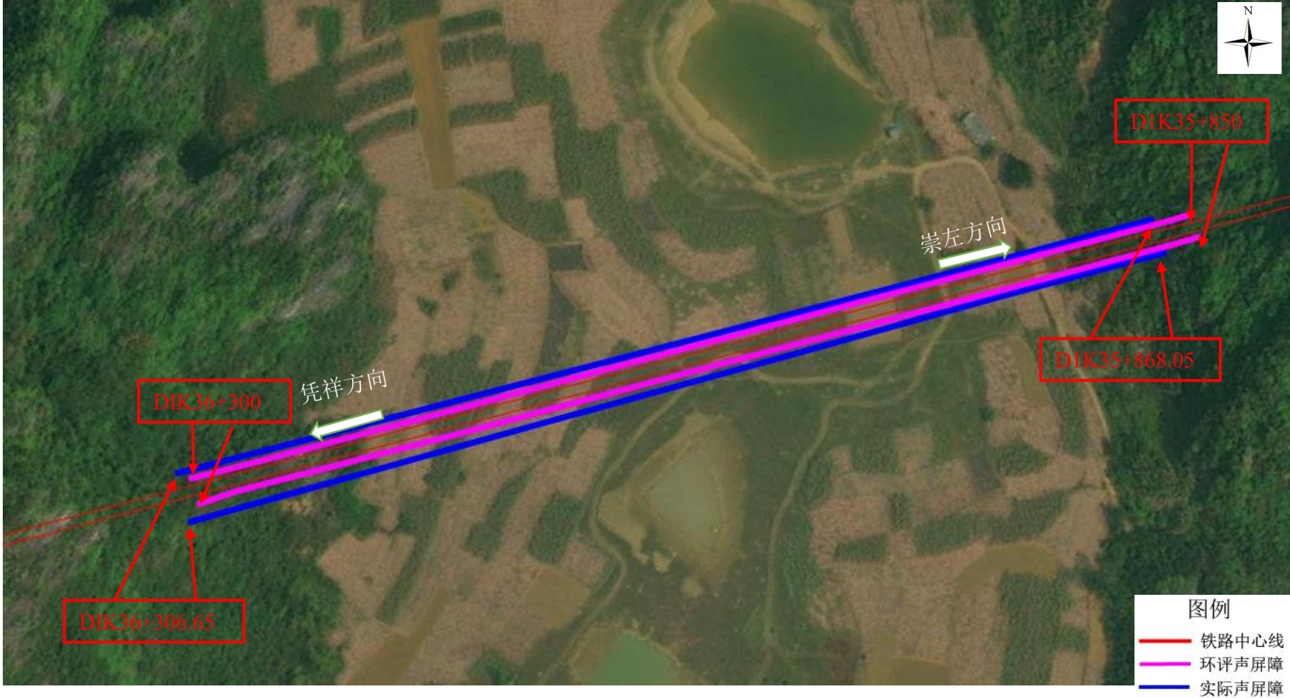
图 6.3-4 (c) 花山国家级风景名胜区内熊猴、猕猴活动区域 2 实际与环评阶段声屏障位置关系示意图 (声屏障减少 20.7m)
