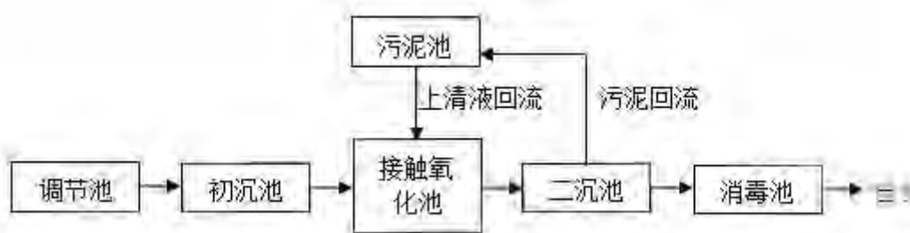
图 5.1-1 生活污水处理设备工艺流程图
