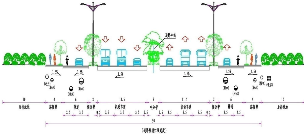
图1.1-1 路基标准断面图
