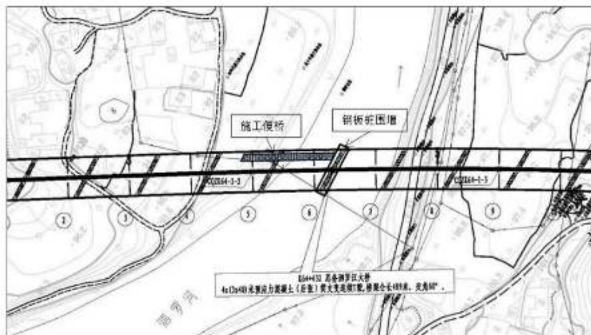
图 2.3-5 思务泗罗江大桥 6#桥墩钢板桩围堰施工平面图
